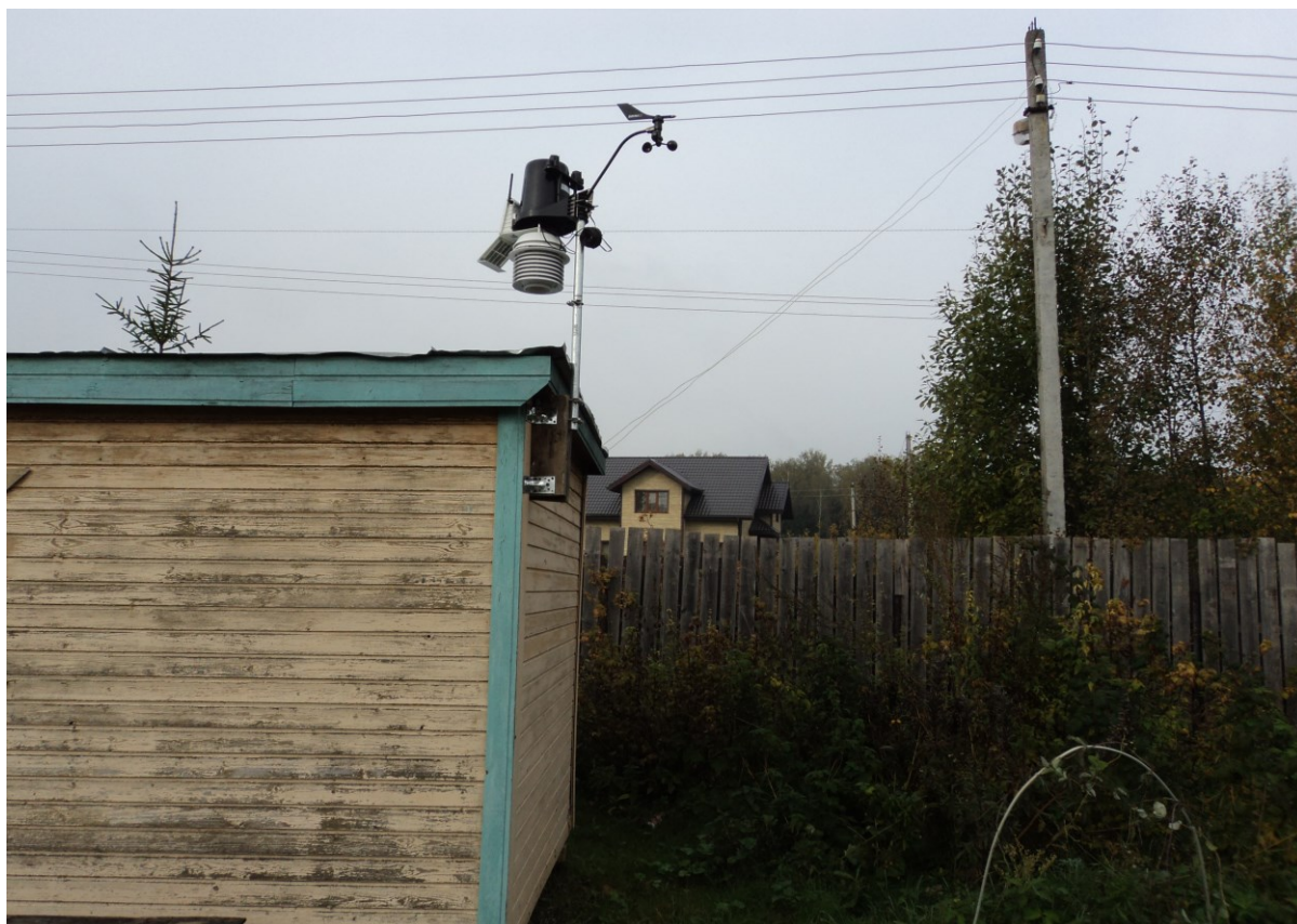
Фото 2.1. Общий вид метеостанции: консоль с датчиками.
