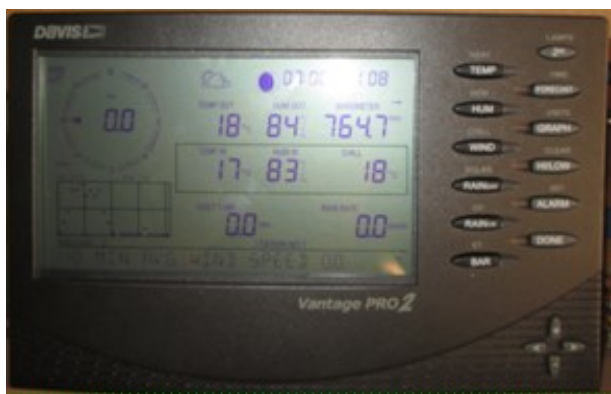
Фото 2.2. Консоль управления для беспроводной метеостанции Vantage Pro2 Davis.
