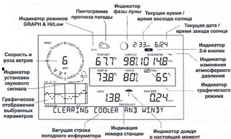
Рис.2.1. Функции дисплея консоли автоматической метеостанции.
