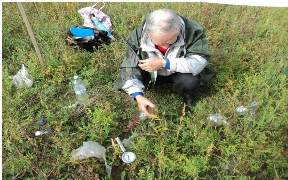
Фото 3.1. Общий вид опытного участка (Площадка №2) с тензиометрами, контролируемыми в работе (дозаправка их водой).
